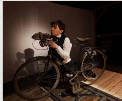
Vélo sur ressort fixé à une structure au sol pour simuler le déplacement de la bicyclette et les chutes.
